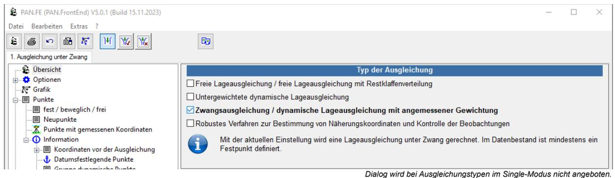
Im „Single-Modus“ kann der Typ der Ausgleichung nicht angegeben werden; er wird von **PANDA/FA** festgelegt. In allen drei Fällen wird der Standard-Ausgleichungstyp: *dynamisch mit angemessener Gewichtung* berechnet. Hierbei werden Besonderheiten, die sich aus der Vorschrift ergeben, automatisch berücksichtigt:
